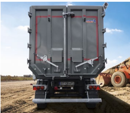
Symmetrisch geteilte Stahl-Kombitür mit Pendelfunktion und Getreideschiebern.*
