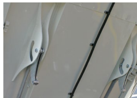
Automatisch-mechanische Hakenverriegelung mit zwei Zugstangen.
