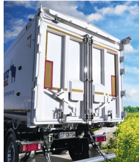
Kombitür: Kontrolliertes Schütten per Getreideschieber, Kippen durch die Pendelklappe, Laden mit geöffneten Türen.
