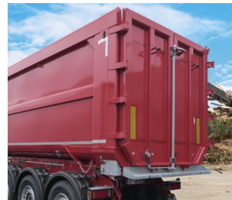
Doppelflügeltür mit Kurzschütte macht die aufliegende Mulde optimal zugänglich.
