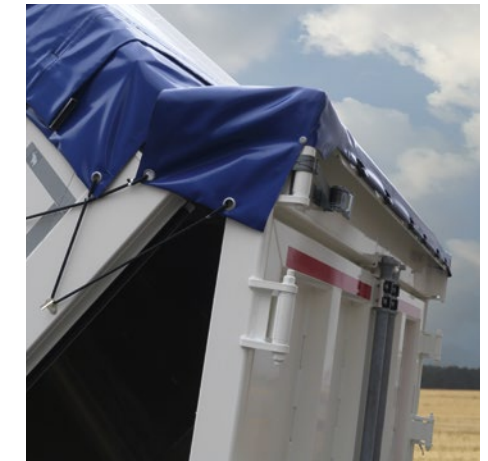
Entleeren über die Pendelfunktion bei geschlossener Rollplane.
