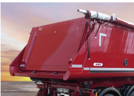
Innen liegende Pendelklappe mit Schütte.
