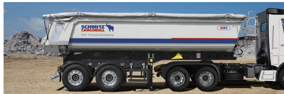
Der tiefe Schwerpunkt der Mulde optimiert die Kippstabilität. Bei zu starker Seitenneigung warnt der Seitenneigungs-Assistent.*
