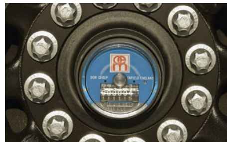
Das Hubodometer an der Radnabe informiert über die Laufleistung des Sattelkipper S.KI.
