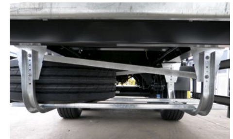
Ersatzrad-Korb unter dem Chassis, vor dem Achsaggregat.
