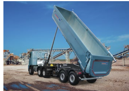
Der tiefe Schwerpunkt der Mulde optimiert die Kippstabilität. Bei zu starker Seitenneigung warnt der Seitenneigungs-Assistent.*
