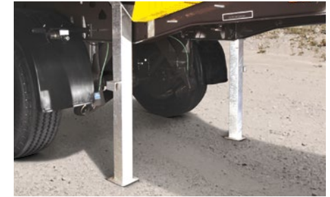
Leichte Steckstützen sind die richtige Lösung für feste Zugeinheiten, deren Trailer selten abgestellt werden.
