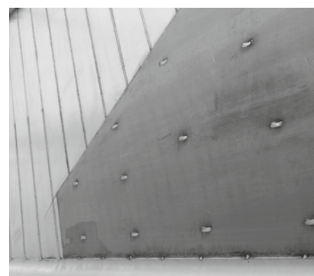
Verschleißbleche optimieren die Widerstandsfähigkeit der Aluminium-Kastenmulde im Heckbereich**.
