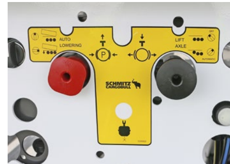
Die automatische Absenkfunktion bietet höhere Standsicherheit beim Kippvorgang und kann im Bedarfsfall deaktiviert werden.
