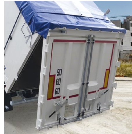
Das Mittelrohr in der Rollplane sorgt für mehr Stabilität der Abdeckung.
