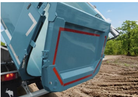
Aufliegende Rückwandklappen mit umlaufender Dichtung und zusätzlichen Spannverschlüssen.
