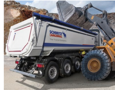
Der flache Boden der Stahl-Rundmulde sorgt für eine niedrigere Ladekante bei gleichem Volumen.
