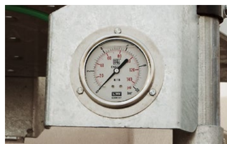
Gegen Überladung: Das Lademanometer zeigt den Luftballdruck.
