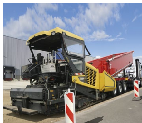
Der klappbare Unterfahrtschutz sorgt beim Abkippen von Asphalt in den Straßenfertiger für mehr Freiraum.
