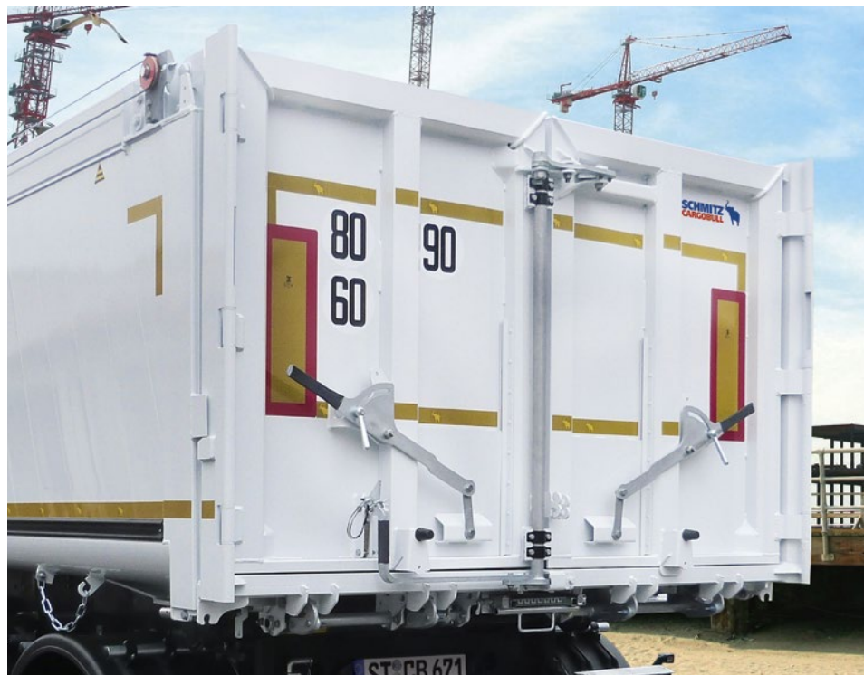
Die Kombitür ermöglicht das Abkippen über eine Pendelfunktion, über Getreideschieber oder Türfunktion.
