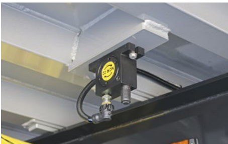
Druckluft-Rollenvibrator für gleichmäßig schnell ablaufendes Schüttgut und kürzere Entladezeiten.
