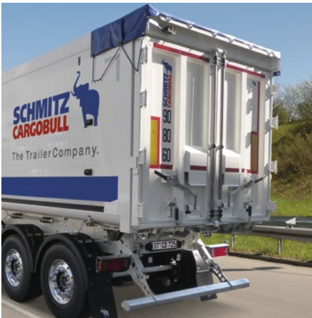
Kombitür mit geschlossenem Pendelrahmen und Türflügeln.
