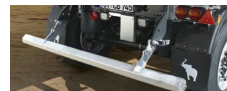
Der klappbare Unterschutz erlaubt ein problemloses Beschicken des Straßenfertigers. Optional mit pneumatischer Betätigung (Bild oben). Der Unterschutz, optimiert für den Fertigerereinsatz, bietet im hochgeklappten Zustand eine verbesserte Bodenfreiheit (Bild in der Mitte).
