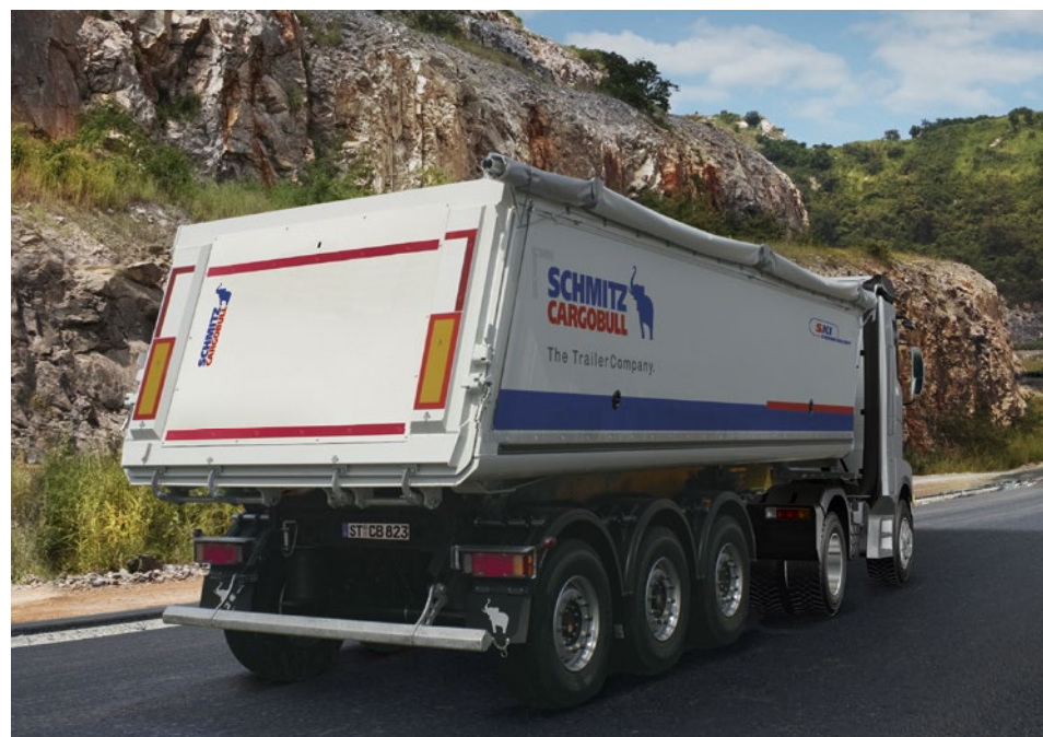
Thermoisolierte Rückwand, wahlweise mit aufliegender Pendelklappe oder innenliegender Pendelklappe mit Schütte.
