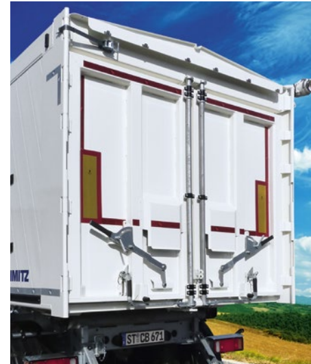
Aluminium-Doppelflügeltür ohne Pendelrahmen mit zwei Getreideschiebern.
