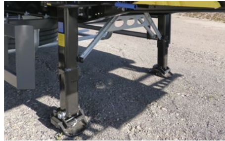
Mechanisches Stützwindwerk mit Ausgleichsfüßen.
