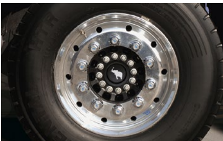
Leichte Aluminium-Felgen zur Gewichtsreduktion und für gute Optik.
